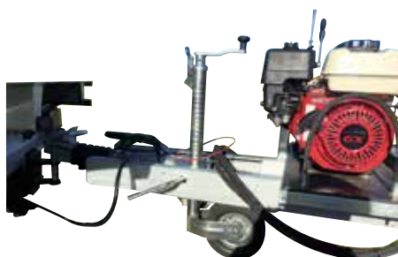
Timon à inertie et centrale hydraulique thermique
