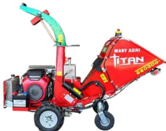
ROUES MOTRICES HYDROSTATIQUES (FACILITÉ DE DÉPLACEMENT SANS MARQUER LE SOL)
