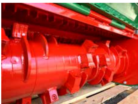
.....● ROTOR FORESTIER MARTEAUX FIXE POINTE CARBURE
